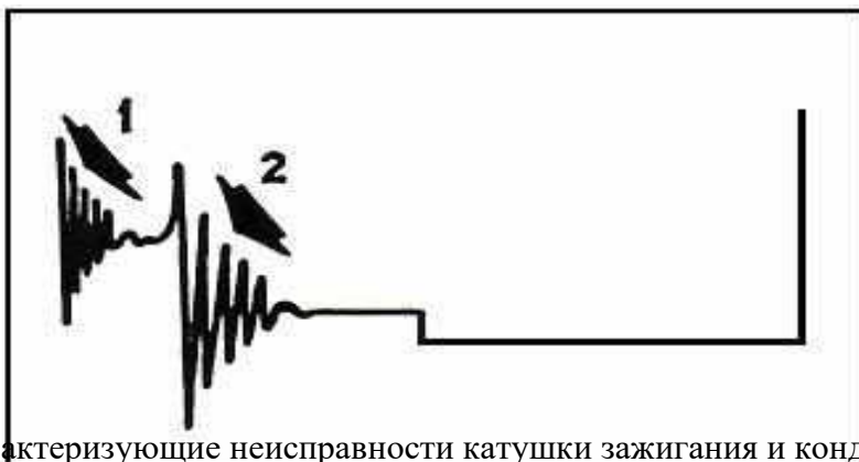
Рис. 4. Нарушение нормальной работы контактов прерывателя
