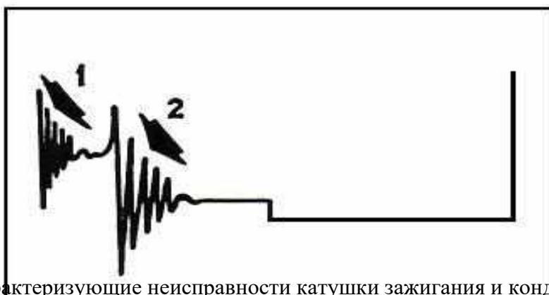
Рис. 4. Нарушение нормальной работы контактов прерывателя
