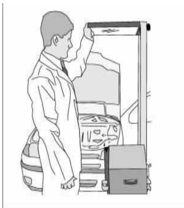
Рисунок 5 - Установка прибора относительно автомобиля.
