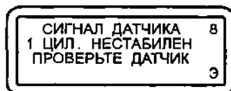
Рис.19. Сигнал синхронизации датчика первого цилиндра нестабилен
