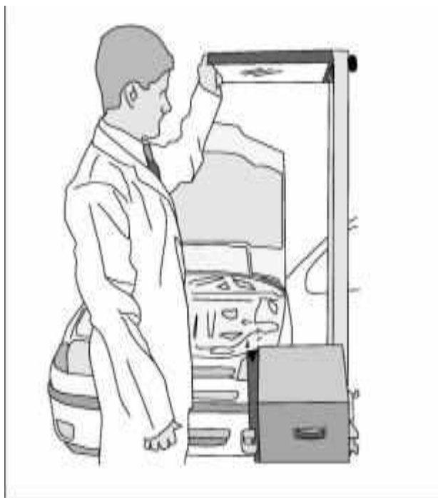
Рисунок 5 - Установка прибора относительно автомобиля.
