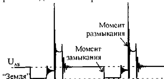
Рис.24. Расположение моментов размыкания и замыкания контактов прерывателя
