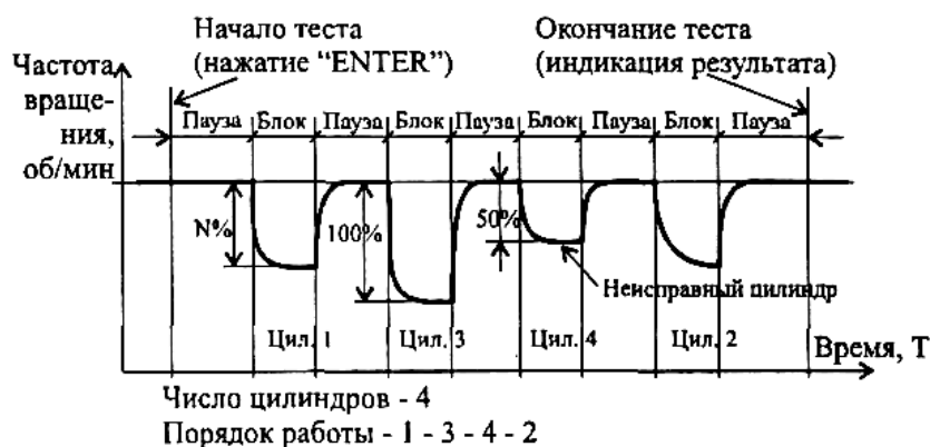
Рис.15. Баланс мощности четырехцилиндрового двигателя
