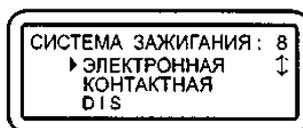
Рис.8. Меню выбора системы зажигания
