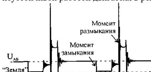
Рис.24. Расположение моментов размыкания и замыкания контактов прерывателя
