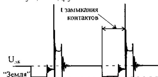
Рис.27. t-замыкания контактов
