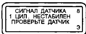
Рис.14. Сигнал синхронизации датчика первого цилиндра нестабилен
