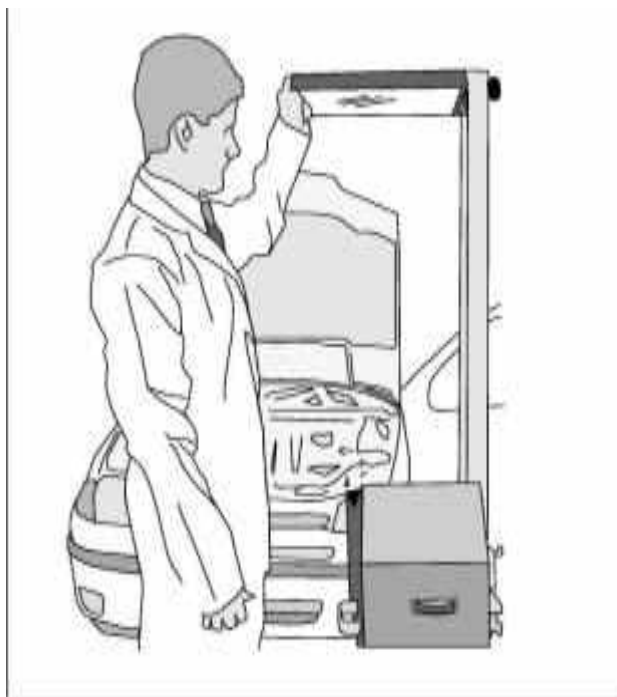
Рисунок 5 - Установка прибора относительно автомобиля.
