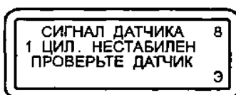
Рис.19. Сигнал синхронизации датчика первого цилиндра нестабилен
