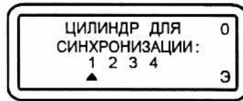
Рис.11. Выбор цилиндра для синхронизации
