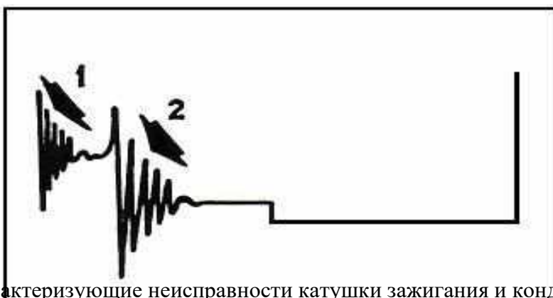
Рис. 4. Нарушение нормальной работы контактов прерывателя
