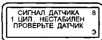
Рис.19. Сигнал синхронизации датчика первого цилиндра нестабилен
