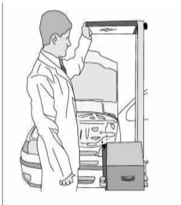
Рисунок 5 - Установка прибора относительно автомобиля.
