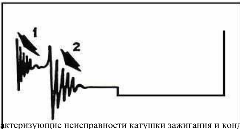
Рис. 4. Нарушение нормальной работы контактов прерывателя
