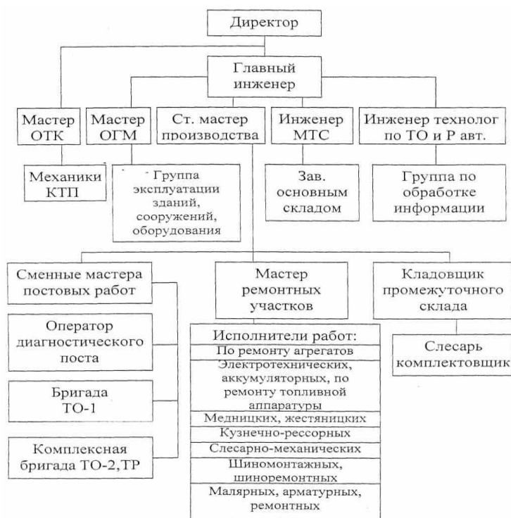
Рис.1. Схема организации производства ТО и ТР подвижного состава при агрегатно-участковом методе.
