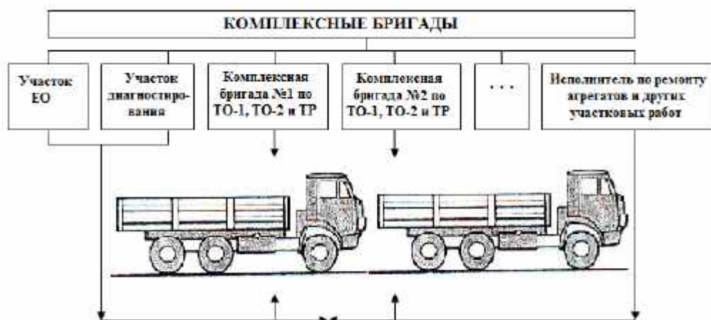
Рис. 2.3. Схема обслуживания подвижного состава методом комплексных бригад
