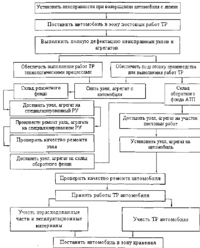
Рис 3. Схема технологического процесса ТР автомобиля агрегатно-узловым методом.
