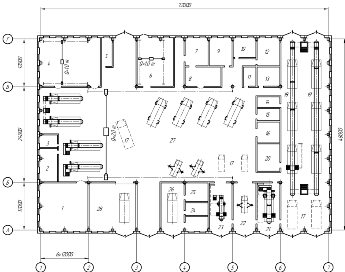
Рис. 7. Планировка производственного корпуса пассажирского АТП на 270 автомобилей: 1 – слесарно-механический участок; 2 – участок обойных и арматурных работ; 3 – участок обслуживания и ремонта таксометров; 4 – участок ремонта агрегатов и узлов автомобилей; 5 – инструментальная кладовая; 6 – склад агрегатов и запасных частей; 7 – участок шиномонтажных и вулканизационных работ; 8 – склад шин; 9 – участок ремонта электрооборудования; 10 – участок ремонта топливной аппаратуры; 11 – санузел; 12 – участок обслуживания, ремонта и зарядки аккумуляторных батарей; 13 – компрессорная; 14 – отдел главного механика; 15 – электрощитовая; 16 – промежуточный склад; 17 – посты ожидания; 18 – линия ТО-1 и общего диагностирования автомобилей; 19 – линия ТО-2; 20 – склад смазочных и эксплуатационных материалов; 21 – пост углубленного диагностирования автомобилей; 22 – пост ТО-2; 23 – пост ТО-1 и диагностирования автомобилей; 24 – вентиляционная камера; 25 – краскоприготовительная; 26 – участок окрасочных работ; 27 – зона текущего ремонта автомобилей; 28 – тепловой участок
