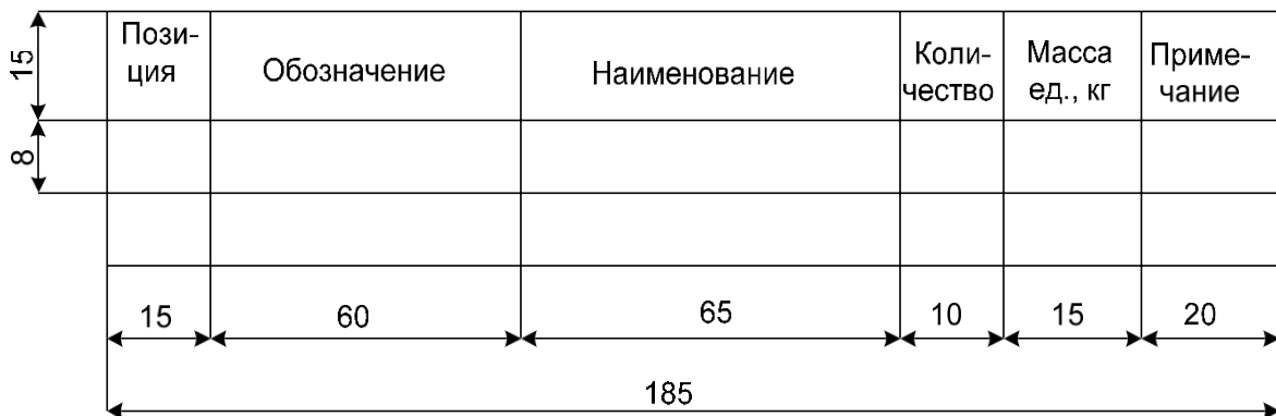
Рис. П6. Форма спецификации технологического оборудования и оргоснастки для планировки зон и участков
