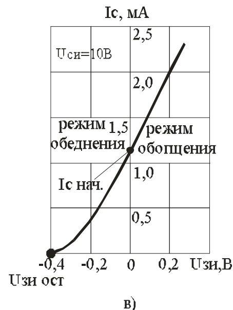
Рисунок 3.4 – Конструкция МДП - транзистора со встроенным каналом n- типа (а); семейство его стоковых характеристик (б); стоко-затворная характеристика (в)
