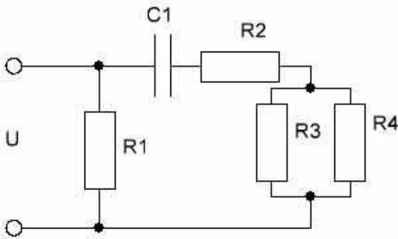
14. Определить мощность, потребляемую цепью постоянного тока, если  $R_1=10\ \text{Ом}$ ,  $R_2=12\ \text{Ом}$ ,  $R_3=15\ \text{Ом}$ ,  $R_4=18\ \text{Ом}$ ,  $R_5=20\ \text{Ом}$ ,  $C_1=10\ \text{мкФ}$ ,  $U=12\ \text{В}$ .
