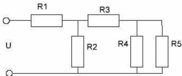
17. Определить напряжение, приложенное к контактам а и в и потребляемую мощность для цепи постоянного тока, если,  $R_1=30 \text{ Ом}$ ,  $R_2=60 \text{ Ом}$ ,  $R_3=20 \text{ Ом}$ ,  $R_4=30 \text{ Ом}$ ,  $R_5=60 \text{ Ом}$ ,  $I_{\text{общ}}=5 \text{ А}$ .
