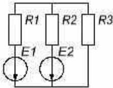
14. Рассчитать токи во всех ветвях электрической цепи методом наложения токов, если  $E_1=6\text{В}$ ,  $E_8=10\text{В}$ ,  $R_1=700\text{ Ом}$ ,  $R_2=300\text{ Ом}$ ,  $R_3=1100\text{ Ом}$ .
