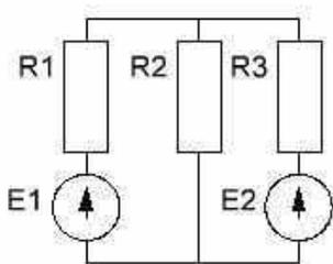
20. Определить токи, протекающие через резисторы, если  $E_1=120$  В,  $E_2=100$  В,  $R_1=80$  Ом,  $R_2=70$  Ом,  $R_3=50$  Ом.
