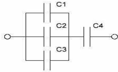
10. Определить общую ёмкость конденсаторов, если  $C_1=30$  пФ,  $C_2=80$  пФ,  $C_3=200$  пФ,  $C_4=10$  мкФ,  $C_5=20$  мкФ.
