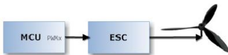
Рисунок 4 – Структурная схема подключения одного двигателя.
