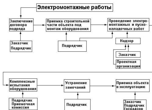
Рис. 2.12 Основные этапы проведения электромонтажных работ
