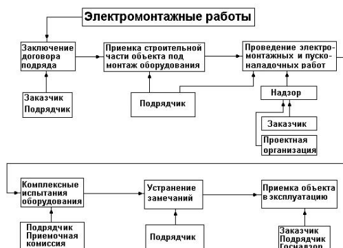
Рис. 2.12 Основные этапы проведения электромонтажных работ
