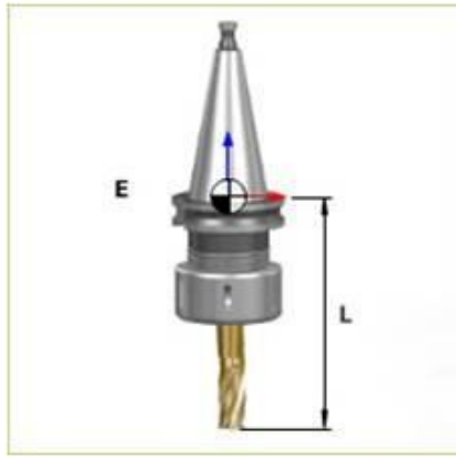
Рисунок 8- Коррекция на длину инструмента
