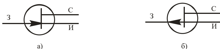
Рисунок 3.2 – Условное обозначение полевого транзистора с р-п-переходом и каналом п-типа (а), каналом р-типа (б)
