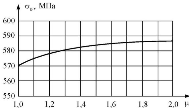
Рис. 8. Изменение прочности стали при холодном деформировании
