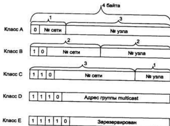
Рис. 1. Структура IP-адреса
