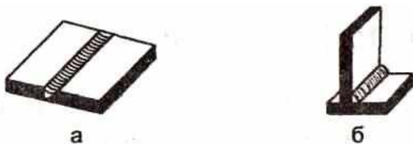
Рис. 40. Стыковой (а) и угловой (б) сварные швы
