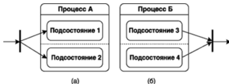
Рисунок 226 – Графическое изображение перехода-разделения в параллельные подсостояния (а) и перехода-слияния из параллельных подсостояний (б)
