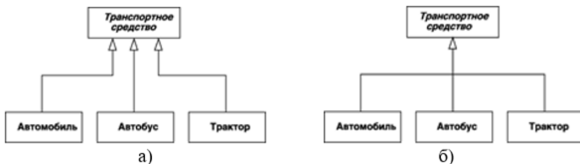
Рисунок 186 – а) Пример графического изображения отношения обобщения для нескольких классов-потомков; б) Альтернативный вариант графического изображения отношения обобщения классов для случая объединения отдельных линий
