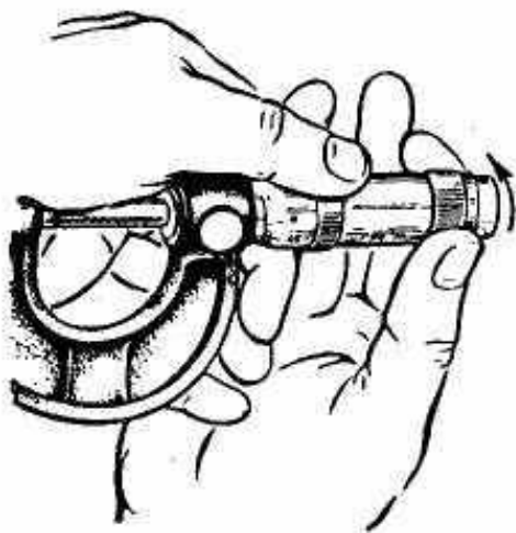
Рис. 7. Закрепление барабана микрометра корпусом трещотки
