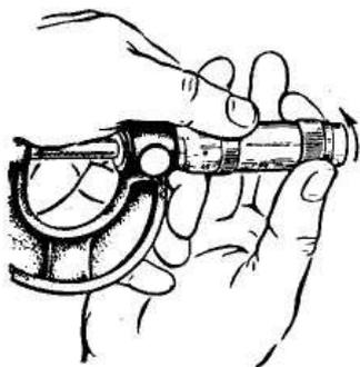
Рис. 7. Закрепление барабана микрометра корпусом трещотки
