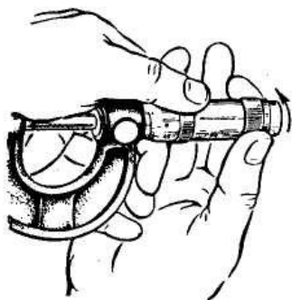
Рис. 7. Закрепление барабана микрометра корпусом трещотки
