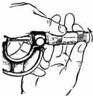
Рис. 7. Закрепление барабана микрометра корпусом трещотки
