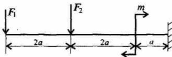
Для консольной балки нагруженной сосредоточенными силами  $F_1=16$  кН,  $F_2=8$  кН и парой сил и моментом  $M=5$  кН\*м, построить эпюры поперечных сил и изгибающих моментов. Материал – сталь,  $[\sigma] = 160$  МПа,  $a = 0,3$  м.
