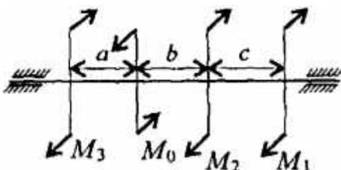
Для стального вала круглого поперечного сечения определить значения внешних моментов, соответствующих передаваемым мощностям  $P_1=2,6$  кВт,  $P_2=3,1$  кВт,  $P_3=3,6$  кВт, и уравновешенный момент. Построить эпюру крутящих моментов по длине вала для предложенной схемы. При расчете использовать
