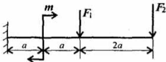
Для консольной балки нагруженной сосредоточенными силами  $F_1=18$  кН,  $F_2=12$  кН и парой сил и моментом  $M=4$  кН\*м, построить эпюры поперечных сил и изгибающих моментов. Материал – сталь,  $[\sigma] = 160$  МПа,  $a = 0,4$  м.
