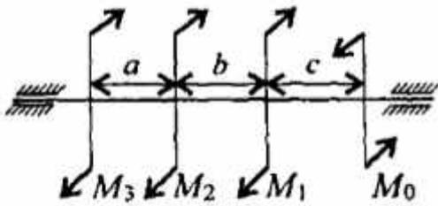
Для стального вала круглого поперечного сечения определить значения внешних моментов, соответствующих передаваемым мощностям  $P_1=2,2$  кВт,  $P_2=2,7$  кВт,  $P_3=3,2$  кВт, и уравновешенный момент. Построить эпюру крутящих моментов по длине вала для предложенной схемы. При расчете использовать следующие данные:  $\omega = 25$  рад/с, материал-сталь,  $[\tau_k] = 30$  МПа,  $G=8 \cdot 10^4$  МПа,  $[\varphi] = 0,02$  рад/м,  $a = b = c = 1,2$  м.
