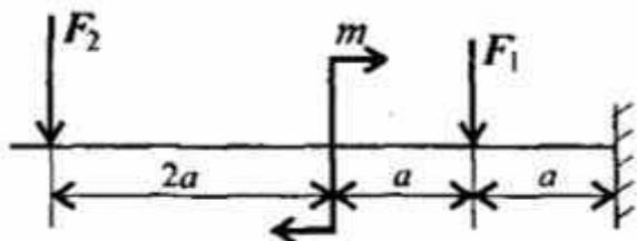
Для консольной балки нагруженной сосредоточенными силами  $F_1=12$  кН,  $F_2=5$  кН и парой сил и моментом  $M=7$  кН\*м, построить эпюры поперечных сил и изгибающих моментов. Материал – сталь,  $[\sigma] = 160$  МПа,  $a = 0,2$  м.
