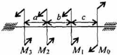
Для стального вала круглого поперечного сечения определить значения внешних моментов, соответствующих передаваемым мощностям  $P_1=2,4$  кВт,  $P_2=2,9$  кВт,  $P_3=3,4$  кВт, и уравновешенный момент. Построить эпюру крутящих моментов по длине вала для предложенной схемы. При расчете использовать следующие данные:  $\omega = 25$  рад/с, материал-сталь,  $[\tau_k] = 30$  МПа,  $G=8 \cdot 10^4$  МПа,  $[\varphi] = 0,02$  рад/м,  $a = b = c = 1,4$  м.
