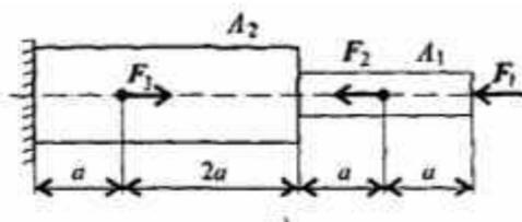
Построить эпюры продольных сил и нормальных напряжений по длине бруса. Определить перемещение свободного конца бруса. Двухступенчатый стальной брус нагружен силами  $F_1=20$  кН,  $F_2=10$  кН,  $F_3=5$  кН. Площади поперечных сечений  $A_1=1,8$  см<sup>2</sup>,  $A_2=3,2$  см<sup>2</sup>.
