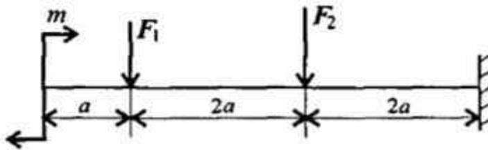
Для консольной балки нагруженной сосредоточенными силами  $F_1=24$  кН,  $F_2=18$  кН и парой сил и моментом  $M=6$  кН\*м, построить эпюры поперечных сил и изгибающих моментов. Материал – сталь,  $[\sigma] = 160$  МПа,  $a = 0,5$  м.
