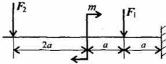
Для консольной балки нагруженной сосредоточенными силами  $F_1=22$  кН,  $F_2=17$  кН и парой сил и моментом  $M=7$  кН\*м, построить эпюры поперечных сил и изгибающих моментов. Материал – сталь,  $[\sigma] = 160$  МПа,  $a = 0,5$  м.
