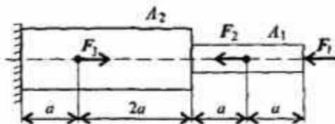
Построить эпюры продольных сил и нормальных напряжений по длине бруса. Определить перемещение свободного конца бруса. Двухступенчатый стальной брус нагружен силами  $F_1=2$  кН,  $F_2=3$  кН,  $F_3 = 5$  кН. Площади
