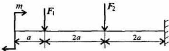
Для консольной балки нагруженной сосредоточенными силами  $F_1=10$  кН,  $F_2=13$  кН и парой сил и моментом  $M=8$  кН\*м, построить эпюры поперечных сил и изгибающих моментов. Материал – сталь,  $[\sigma] = 160$  МПа,  $a = 0,4$  м.
