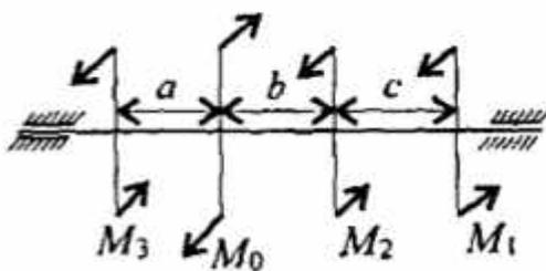
Для стального вала круглого поперечного сечения определить значения внешних моментов, соответствующих передаваемым мощностям  $P_1=2,5$  кВт,  $P_2=3,0$  кВт,  $P_3=3,5$  кВт, и уравновешенный момент. Построить эпюру крутящих моментов по длине вала для предложенной схемы. При расчете использовать следующие данные:  $\omega = 25$  рад/с, материал-сталь,  $[\tau_k] = 30$  МПа,  $G=8 \cdot 10^4$  МПа,  $[\varphi] = 0,02$  рад/м,  $a = b = c = 1,5$  м.
