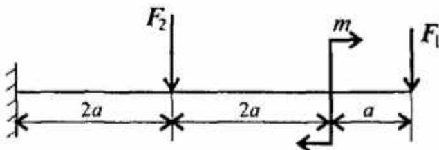
Для консольной балки нагруженной сосредоточенными силами  $F_1=10$  кН,  $F_2=4$  кН и парой сил и моментом  $M=8$  кН\*м, построить эпюры поперечных сил и изгибающих моментов. Материал – сталь,  $[\sigma] = 160$  МПа,  $a = 0,2$  м.
