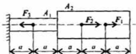
Построить эпюры продольных сил и нормальных напряжений по длине бруса. Определить перемещение свободного конца бруса. Двухступенчатый стальной брус нагружен силами  $F_1=26$  кН,  $F_2=20$  кН,  $F_3=10$  кН. Площади поперечных сечений  $A_1 = 1,6$  см<sup>2</sup>,  $A_2=2,4$  см<sup>2</sup>.  $a=0,3$  м. Принять  $E=2*10^5$  Н/мм<sup>2</sup>.
