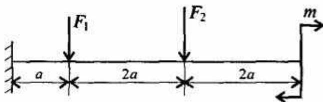
Для консольной балки нагруженной сосредоточенными силами  $F_1=14$  кН,  $F_2=8$  кН и парой сил и моментом  $M=6$  кН\*м, построить эпюры поперечных сил и изгибающих моментов. Материал – сталь,  $[\sigma] = 160$  МПа,  $a = 0,3$  м.
