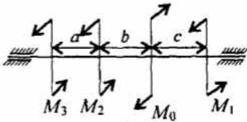
Для стального вала круглого поперечного сечения определить значения внешних моментов, соответствующих передаваемым мощностям  $P_1=2,3$  кВт,  $P_2=2,8$  кВт,  $P_3=3,3$  кВт, и уравновешенный момент. Построить эпюру крутящих моментов по длине вала для предложенной схемы. При расчете использовать следующие данные:  $\omega = 25$  рад/с, материал-сталь,  $[\tau_k] = 30$  МПа,  $G=8 \cdot 10^4$  МПа,  $[\varphi] = 0,02$  рад/м,  $a = b = c = 1,3$  м.
