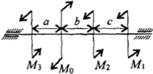
Для стального вала круглого поперечного сечения определить значения внешних моментов, соответствующих передаваемым мощностям  $P_1= 2,5$  кВт,  $P_2=3,0$  кВт,  $P_3= 3,5$  кВт, и уравновешенный момент. Построить эпюру крутящих моментов по длине вала для предложенной схемы. При расчете использовать следующие данные:  $\omega = 25$  рад/с, материал-сталь,  $[\tau_k] = 30$  МПа,  $G=8 \cdot 10^4$  МПа,  $[\varphi] = 0,02$  рад/м,  $a = b = c = 1,5$  м.
