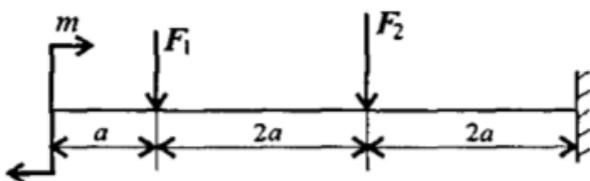
Для консольной балки нагруженной сосредоточенными силами  $F_1=10\text{кН}$ ,  $F_2=13\text{кН}$  и парой сил и моментом  $M=8\text{кН*м}$ , построить эпюры поперечных сил и изгибающих моментов. Материал –сталь,  $[\sigma] = 160\text{МПа}$ ,  $a = 0,4\text{ м}$ .
