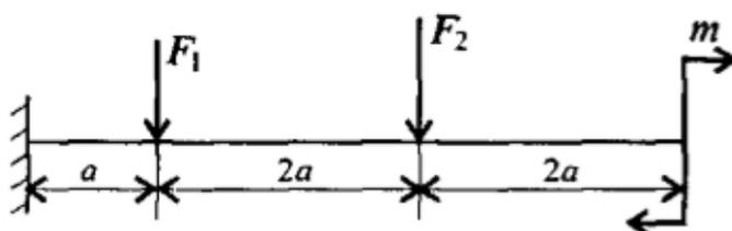
Для консольной балки нагруженной сосредоточенными силами  $F_1=28 \text{ кН}$ ,  $F_2=24 \text{ кН}$  и парой сил и моментом  $M=4 \text{ кН*м}$ , построить эпюры поперечных сил и изгибающих моментов. Материал – сталь,  $[\sigma]=160 \text{ МПа}$ ,  $a=0,6 \text{ м}$ .
