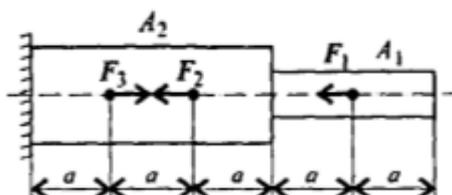
Построить эпюры продольных сил и нормальных напряжений по длине бруса. Определить перемещение свободного конца бруса. Двухступенчатый стальной брус нагружен силами  $F_1=20 \text{ кН}$ ,  $F_2=8 \text{ кН}$ ,  $F_3=4 \text{ кН}$ .
