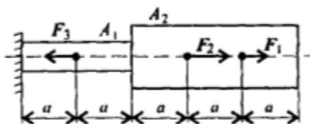
Построить эпюры продольных сил и нормальных напряжений по длине бруса. Определить перемещение свободного конца бруса. Двухступенчатый стальной брус нагружен силами  $F_1=26 \text{ кН}$ ,  $F_2=20 \text{ кН}$ ,  $F_3=10 \text{ кН}$ . Площади поперечных сечений  $A_1=1,6 \text{ см}^2$ ,  $A_2=2,4 \text{ см}^2$ .  $a=0,3 \text{ м}$ .
