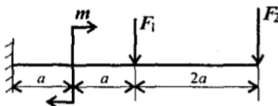
Для консольной балки нагруженной сосредоточенными силами  $F_1=18\text{кН}$ ,  $F_2=12\text{кН}$  и парой сил и моментом  $M=4\text{кН*м}$ , построить эпюры поперечных сил и изгибающих моментов. Материал –сталь,  $[\sigma] = 160\text{МПа}$ ,  $a = 0,4\text{ м}$ .
