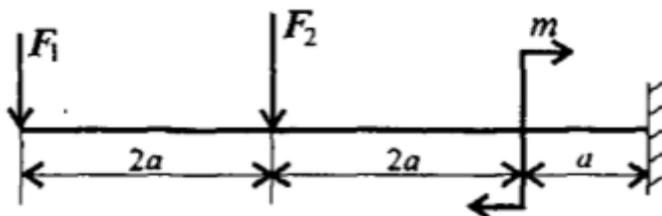
Для консольной балки нагруженной сосредоточенными силами  $F_1=26 \text{ кН}$ ,  $F_2=22 \text{ кН}$  и парой сил и моментом  $M=5 \text{ кН*м}$ , построить эпюры поперечных сил и изгибающих моментов. Материал – сталь,  $[\sigma]=160 \text{ МПа}$ ,  $a=0,6 \text{ м}$ .
