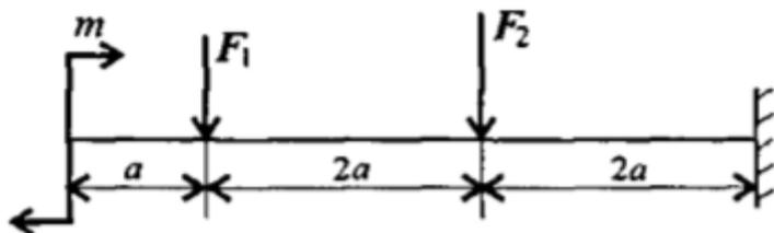
Для консольной балки нагруженной сосредоточенными силами  $F_1=24\text{кН}$ ,  $F_2=18\text{кН}$  и парой сил и моментом  $M=6\text{кН*м}$ , построить эпюры поперечных сил и изгибающих моментов. Материал –сталь,  $[\sigma] = 160\text{МПа}$ ,  $a = 0,5\text{м}$ .
