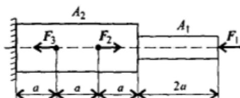
Построить эпюры продольных сил и нормальных напряжений по длине бруса. Определить перемещение свободного конца бруса. Двухступенчатый стальной брус нагружен силами  $F_1=17 \text{ кН}$ ,  $F_2=13 \text{ кН}$ ,  $F_3=8 \text{ кН}$ . Площади поперечных сечений  $A_1=2 \text{ см}^2$ ,  $A_2=2,5 \text{ см}^2$ .  $a=0,5 \text{ м}$ . Принять  $E=2 \cdot 10^5 \text{ Н/мм}^2$ .
