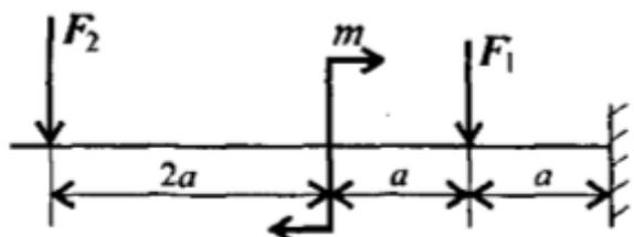
Для консольной балки нагруженной сосредоточенными силами  $F_1=22\text{кН}$ ,  $F_2=17\text{кН}$  и парой сил и моментом  $M=7\text{кН*м}$ , построить эпюры поперечных сил и изгибающих моментов. Материал –сталь,  $[\sigma] = 160\text{МПа}$ ,  $a = 0,5\text{ м}$ .
