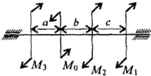
Для стального вала круглого поперечного сечения определить значения внешних моментов, соответствующих передаваемым мощностям  $P_1= 2,6$  кВт,  $P_2=3,1$  кВт,  $P_3= 3,6$  кВт, и уравновешенный момент. Построить эпюру крутящих моментов по длине вала для предложенной схемы. При расчете использовать следующие данные:  $\omega = 25$  рад/с, материал-сталь,  $[\tau_k] = 30$  МПа,  $G=8 \cdot 10^4$  МПа,  $[\varphi] = 0,02$  рад/м,  $a = b = c = 1,6$  м.
