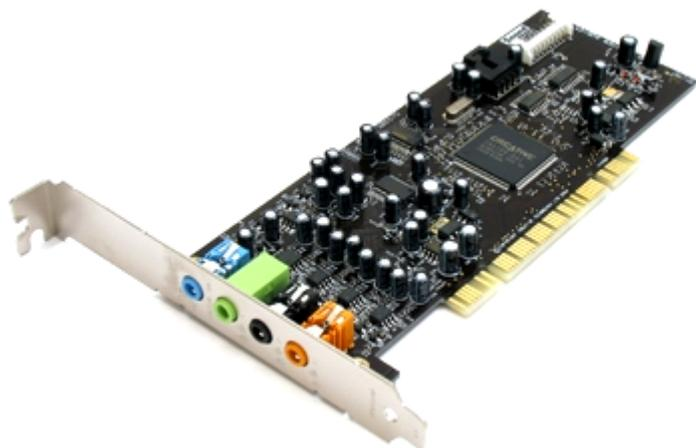
Она устанавливается в один из разъемов материнской платы в виде дочерней карты и выполняет вычислительные операции, связанные с обработкой звука, речи, музыки. В отсутствие повышенных требований к качеству звука можно использовать интегрированные звуковые системы, в которых функции об-
