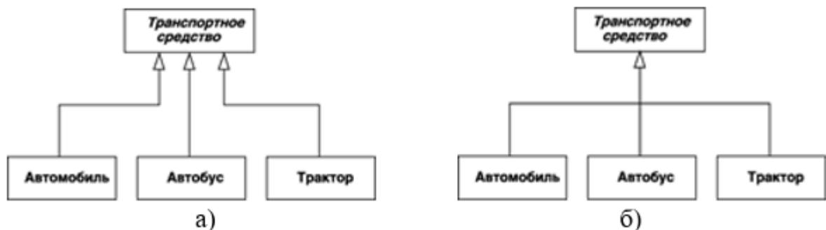
Рисунок 55 – а) Пример графического изображения отношения обобщения для нескольких классов-потомков; б) Альтернативный вариант графического изображения отношения обобщения классов для случая объединения отдельных линий
