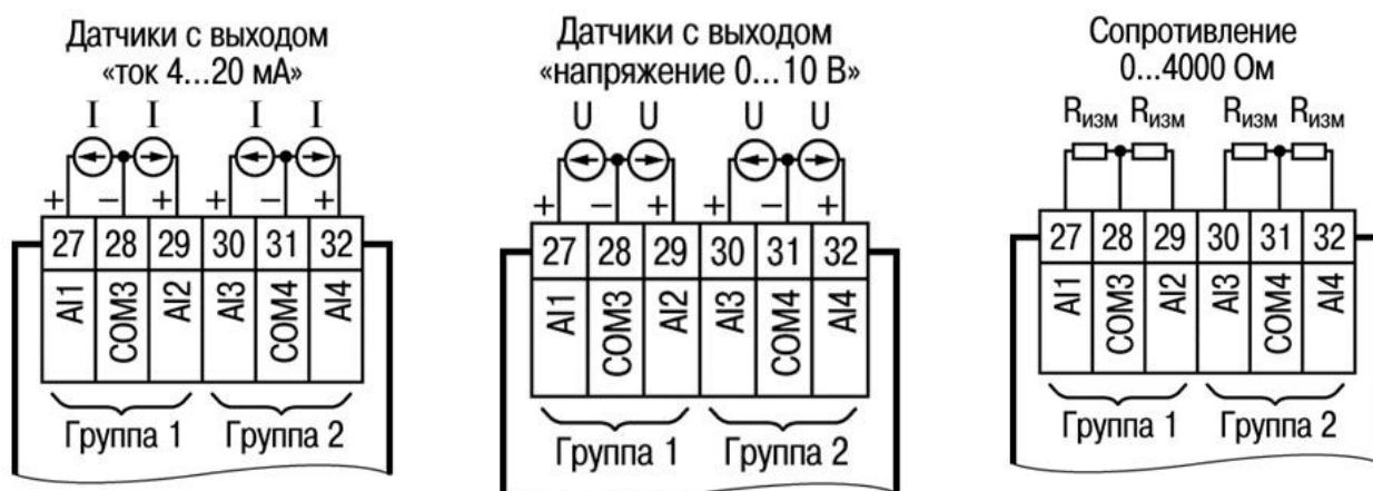
Рисунок 1 – Схема подключения аналоговых датчиков к ПР200
