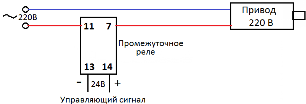
Рисунок 2 – Схема управления приводом 220 В через промежуточное реле.
