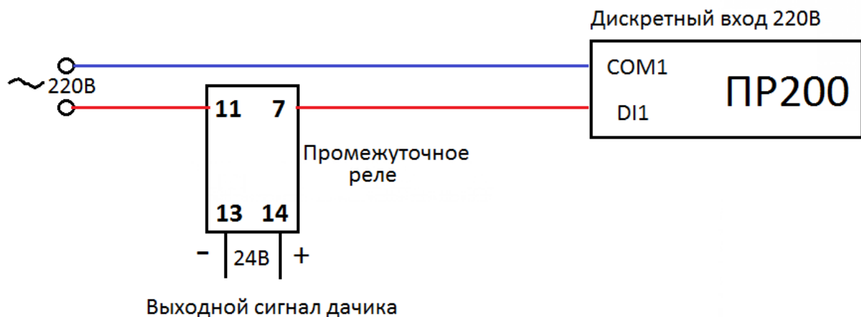
Рисунок 3 – Схема подключения дискретного датчика 24 В к ПР200 с напряжением дискретных входов 220 В.
